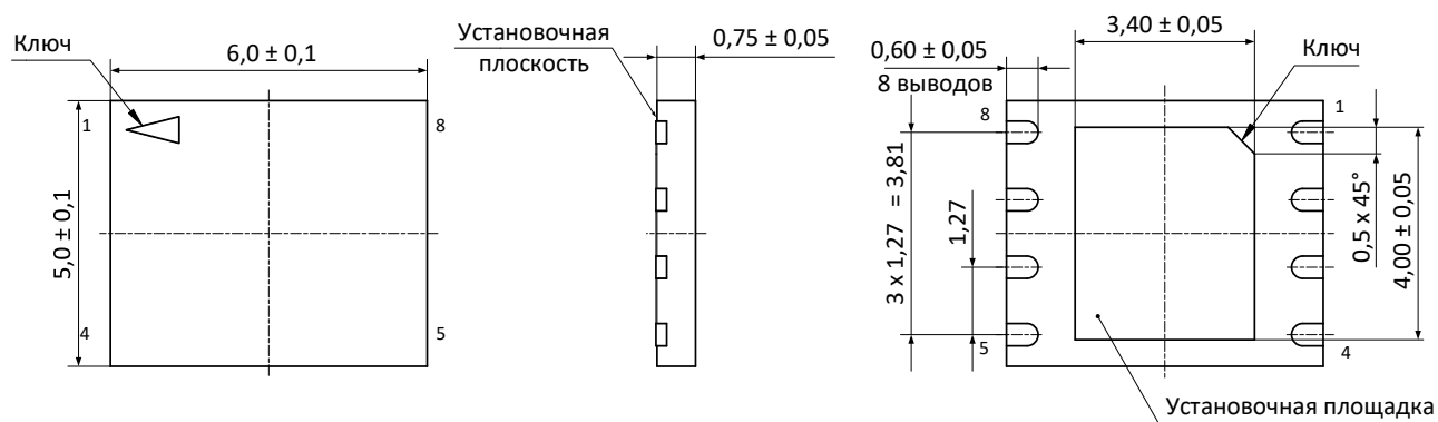
Рисунок 17 – Микросхема в корпусе DFN8 5×6×0,75 (1,27)
